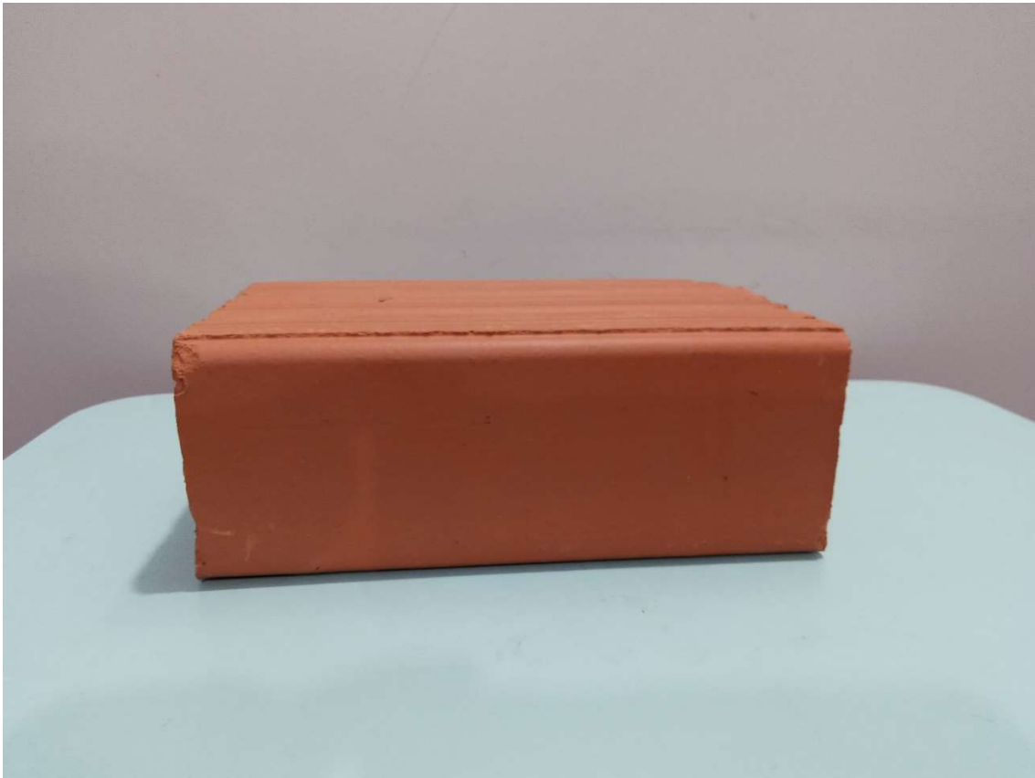
Amostra de bloco cerâmico já existente na edificação.
